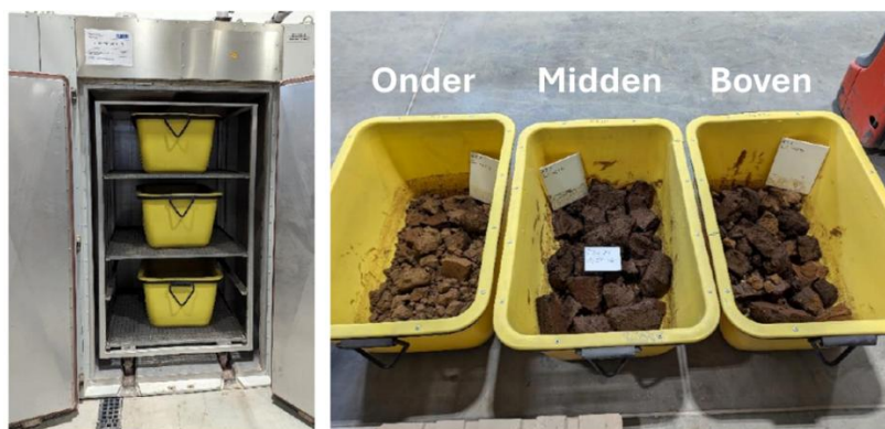
Figuur 10 Links: de droogkast bij IAB Weimar waarin het slib gedroogd is. Rechts: het slib gedroogd op verschillende planken in de droogkast. Op de onderste plank droogt het slib sneller.
