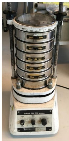
Figuur 27 zeef-opstelling bestaande uit een 500 \mu\text{m} , een 1000 \mu\text{m} , een 2000 \mu\text{m} , een 3350 \mu\text{m} en een 4000 \mu\text{m} zeef.
