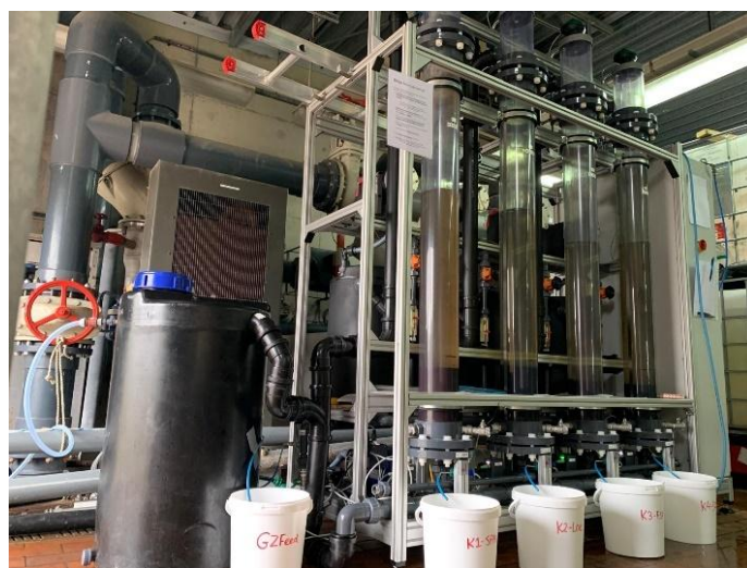
Figuur 17 Fosfaatadsorptie opstelling in Geestmerambacht
