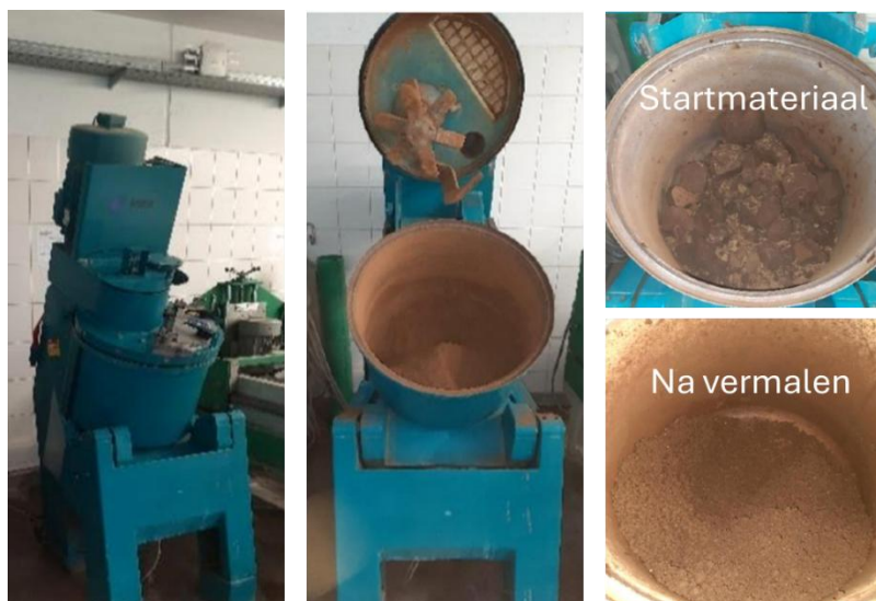
Figuur 7 De Eirich-mixer welke gebruikt werd voor het vermalen van het slib bij IAB Weimar.
