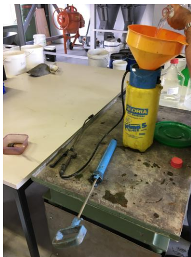
Figuur 39 De vernevelaar welke gebruikt is tijdens het pelletieren voor het toevoegen van bindmiddeloplossing
