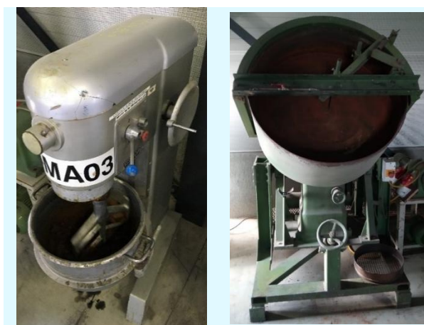
Figuur 24 Apparatuur gebruikt voor pelleteerexperimenten. Links: Hobart®-menger voor slib en bindmiddel. Rechts: rotating disk.
